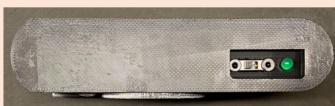
Abbildung 5: Unterseite 3D-gedrucktes Kameragehäuse
